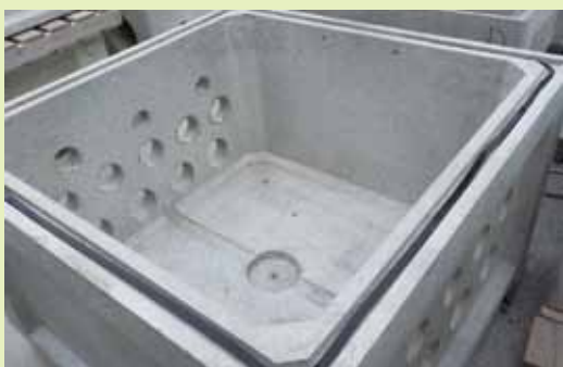
③ 同梱のパッキンを付けます。 接着面の油・埃等を拭き取って下さい。 継目は10cm程度重ね合わせて下さい。
